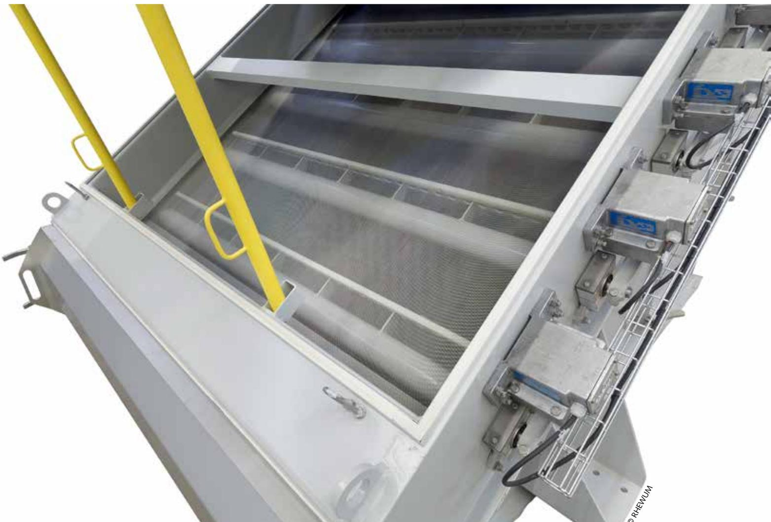
3 Siebmaschine mit direkter Erregung des Siebgewebes • Screening machine with direct excitation of the screen cloth
